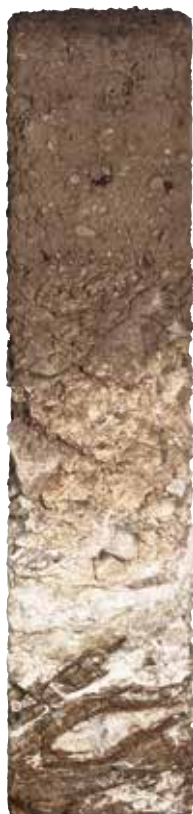
Bodenprofil der Wachauer Ried Achleiten. Unter dem Oberboden erkennt man Gneis, darunter Amphibolite mit Kalkausfällungen.
